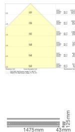
**Technische Daten Ledvance LED Panel Linear Pendelleuchte IndiviLED 52W
