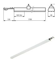
Technische Daten Philips LED Tragschiene Coreline
